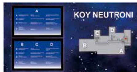
Suuri aulaopaste jossa yritysten nimet tv-näytöllä. Näyttö integroitu alumiini koteloon jossa tulostettu rakennuksen opastekartta.
